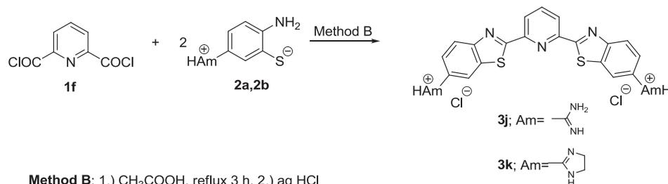
**Method B**; 1.) CH<sub>3</sub>COOH, reflux 3 h, 2.) aq HCl
