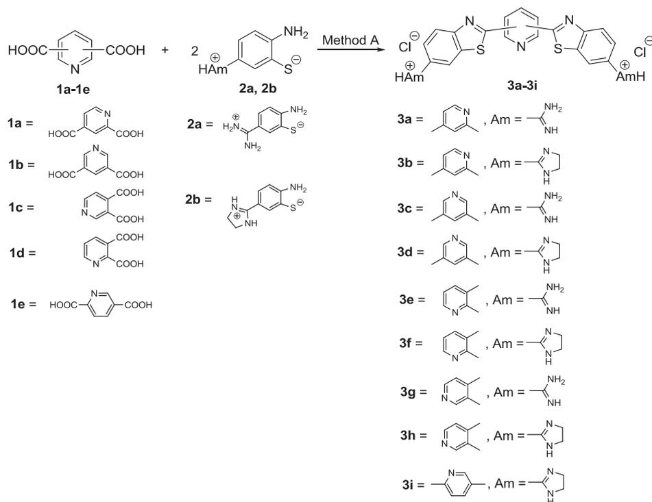
**Method A** 1.) PPA 120–140°C, 1h then 160–180°C, 2h; 2.) 2M NaOH; 3.) CH<sub>3</sub>COOH/HCl or EtOH/HCl
